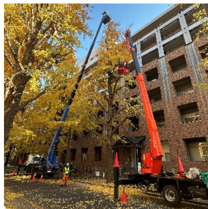
写真5 伸縮式と屈曲式ブーム型を備えた高所作業車状況 ©T.NOMURA
