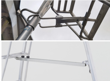
脚の角度を確実に保つための金具等の例
